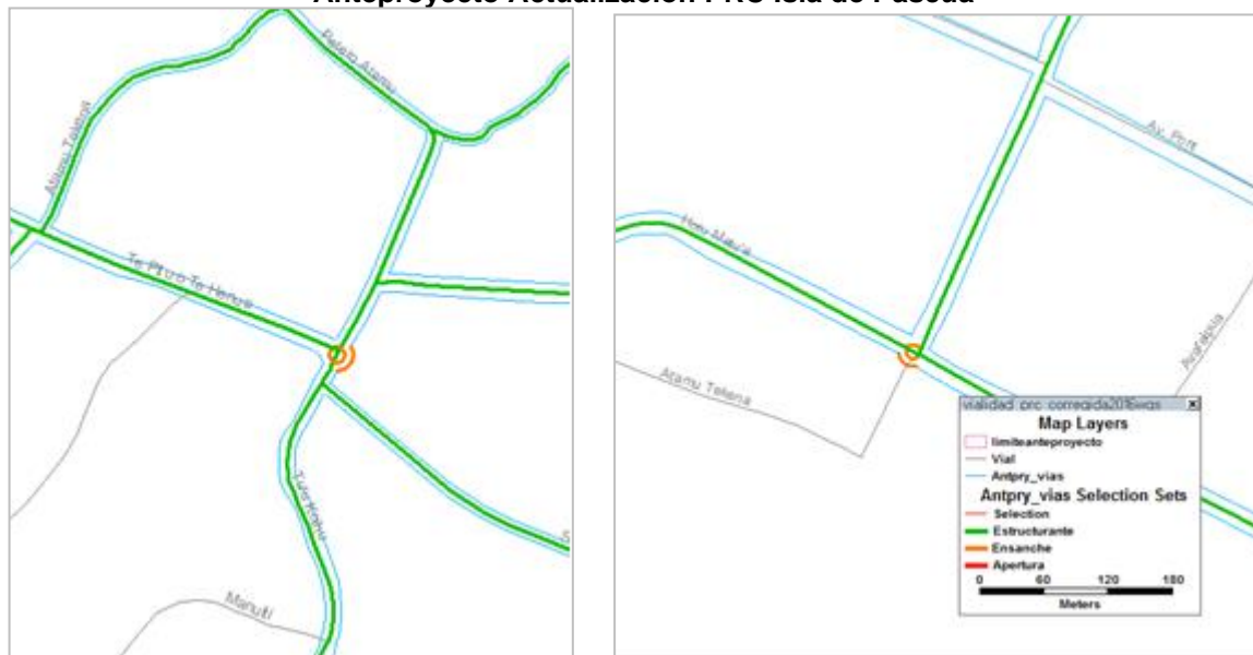
Ilustración 25 Rotondas en Te Pito o Te Henua y Hotu Matu'a Anteproyecto Actualización PRC Isla de Pascua
